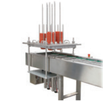
ΣΤΑΚΑΡΙΣΤΙΚΟ ΣΚΕΥΩΝ ΜΕ ΒΑΣΗ TRAY DE-NESTER DEVICE
