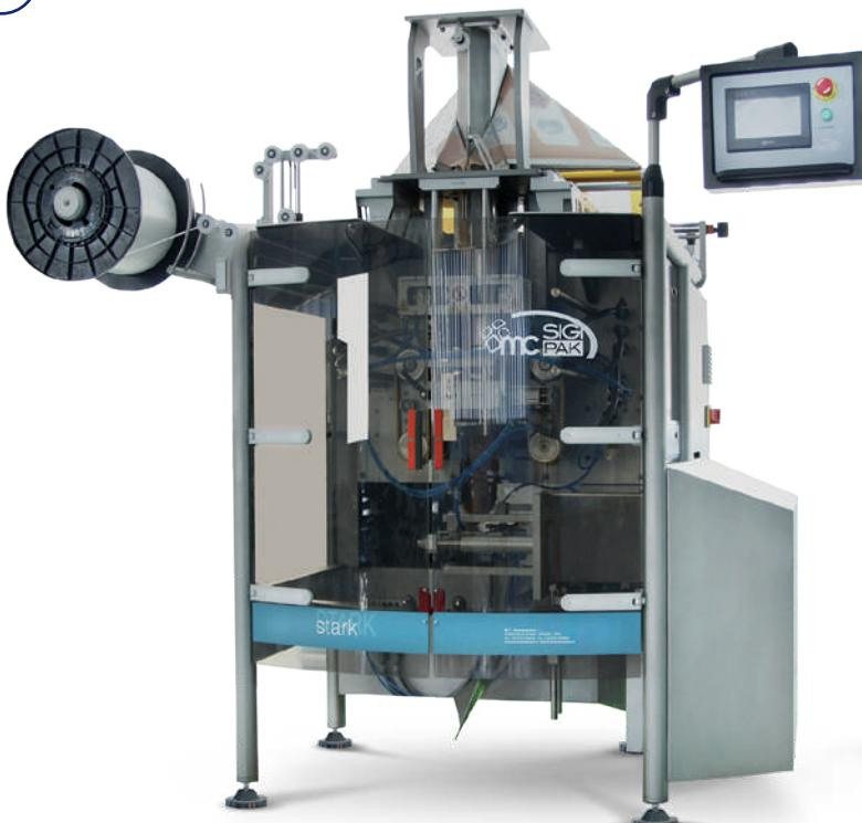
Κάθετη μηχανή συσκευασίας Stark
